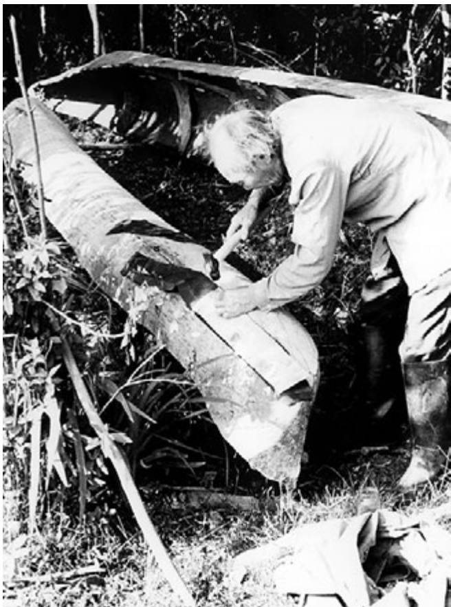
И.И. Третьяков ремонтирует старую долбленную лодку: снаружи на трещину прибивают металлическую заплату с тканевой или резиновой прокладкой, трещину заливают варом (раньше смолой ели, пихты, лиственницы). с. Удское. 1993. Фото Валерия Спидлена
